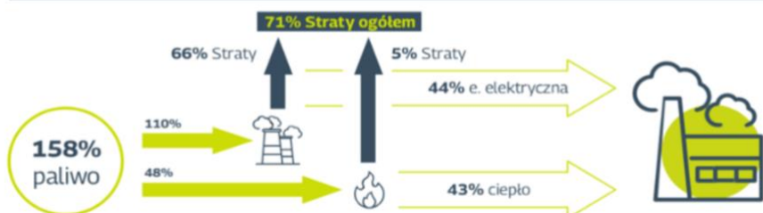
Rysunek 3.6 Schemat korzyści płynących z zastosowania kogeneracji
